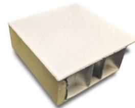
LiDAR 漫反射目标板的厚度为 18.5mm，基板是蜂窝式铝板。这种基板设计具有机械平坦，坚固耐用且轻巧的特点。有四种标准尺寸漫反射目标板可供选择；0.5 m x 0.5 m，1.0 m x 1.0 m，1.5 m x 1.5 m 和 1.2 m x 2.4 m（可安装或不可安装）。
