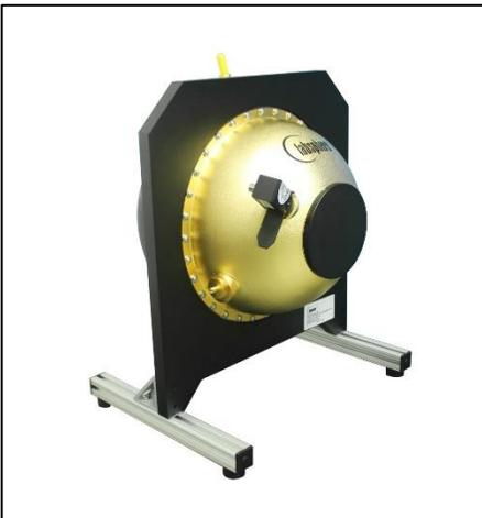
水冷激光功率积分球为高功率脉冲和连续激光测试而设计，它有 3 种尺寸。积分球采用的是 Labsphere（蓝菲光学）漫反射镀金涂料 Infragold®，可以测量 700nm-20μm 波段的激光。可测单位面积上最大功率强度为 2kw/cm<sup>2</sup>的激光同时可以极大地减少积分球本身引起的功率损耗。
