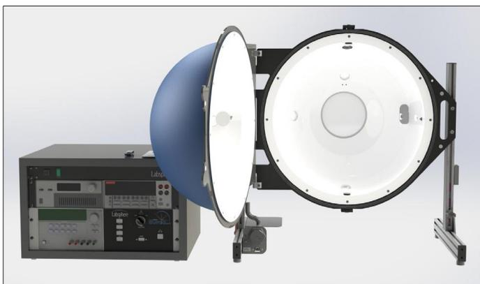
LED 制造商、集成商以及用户非常关注 LED 的光学、热学和电学特性，因为结温的变化将影响 LED 的颜色、光通量、寿命、发光效率及线性特征。
