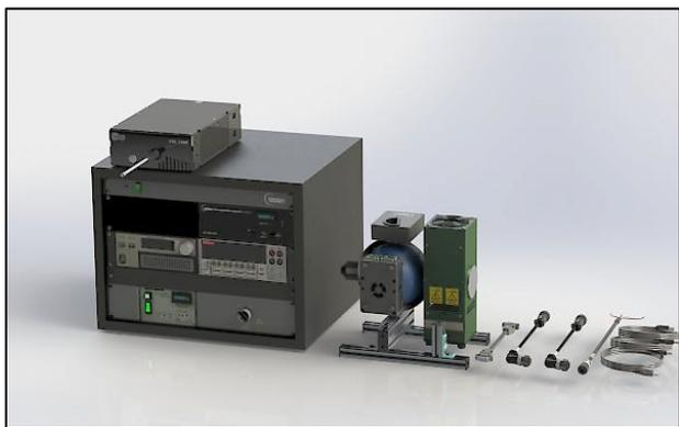
蓝菲光学（Labsphere）的高精度 UV（紫外）LED 测试系统可以对 UV LED 实现绝对值测量，结果可溯源至 NIST。
