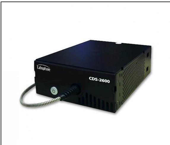
CDS 2600 交叉式 Czerny-Turner 光谱仪，带有热电偶电冷却功能和薄型背照式 CCD 探测器，内部集成了机械快门用于实时暗背景扣除。与蓝菲光学的光度测试系统、校准与辅助硬件以及 Integral®光测量软件搭配使用时可以获得待测设备的全波段的光谱辐射度、光度、色度、电学及温度参数。
