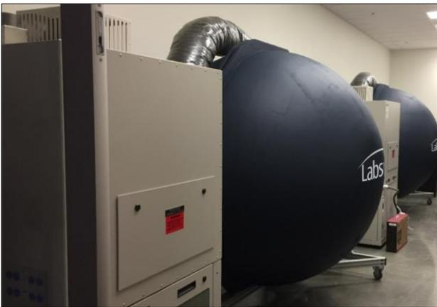
当固态光引擎用于灯具或固定装置时，led 附近的热环境会受到设计和应用环境的影响。一个灯具通过测量灯具在不同温度下的性能特征，就可以建立工作温度和光输出的关系模型。蓝菲光学（Labsphere）的 illumia®Plus2 温控积分球光谱仪测试系统是依据 IES LM-82 和 LM-79-19 建议的方法在较宽的动态温度范围内测试光度和比色性能而专门设计的。系统包括一个积分球（尺寸 1.65 米和 2 米可选）与温度控制反馈回路，应用特定模块，认证的标准灯和 Integral®软件。
