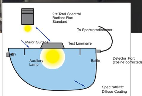
半积分球光谱仪测量系统设计用于测量前向发光灯，LED，板载和用于固态照明（SSL）的散热 LED 光引擎，采用 Spectrafect® 涂层半球，内部带有镜面，可在内部创建虚拟积分球。镜像表面中央放置的端口允许被测设备（DUT）内部安装在虚拟球体的中心，同时保持 DUT 的电气和热控制，减少传统球体中可能出现的吸收误差。
