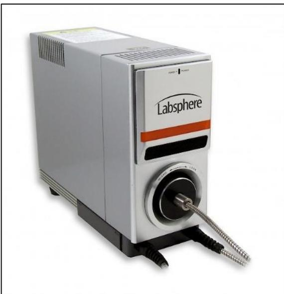
CDS 3020/3030 高端面阵 CCD 制冷光谱仪具有超低杂散光、高灵敏度、高动态范围、高重复性、光谱选择范围广（覆盖 UV-VIS-NIR）的特点，光纤可自由变更方向而不影响光信号传输。改光谱仪具有外部触发功能，非常适用于紫外线定量评价、量子效率测试、在线测试等高精度测试分析，通过与蓝菲光学的其他产品配合使用，该光谱仪能提供一体化光谱校准，对于各种光源（从传统照明灯具到全新的固体照明元件和模块）进行完整的总光谱辐射通量、光度计色度特性分析。
