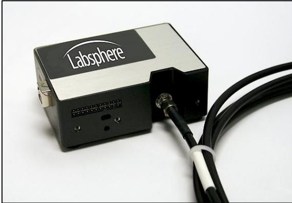
CDS-600/610 阵列光谱仪是一款快速光谱分析器，主要用于实时光谱分析，瞬时光谱采集功能。可以测得待测器件（DUT）在辐射、光度和色彩方面的多种特性。该高灵敏度 CCD 阵列光谱仪具有噪音低、光谱响应范围广的特点，它配合 LabSphere 积分球技标准源使用，即便针对一些窄带光源应用，如 LED、荧光灯和放电灯，也能获得精确的测量数据。
